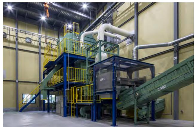
第3工場に設置した縦型破碎機
